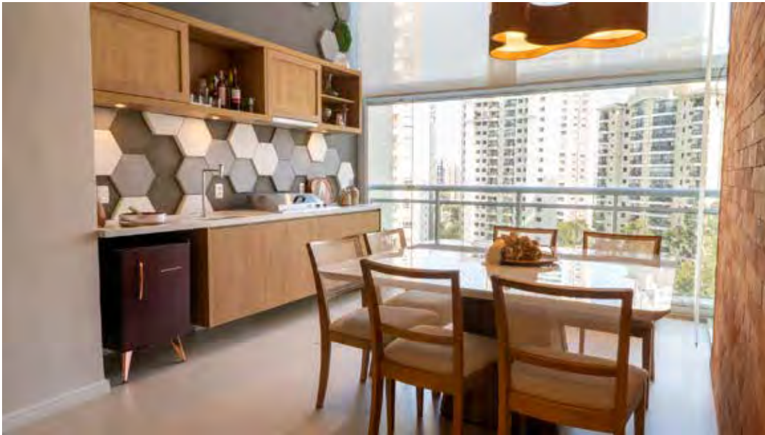
A espessura dos vidros da varanda costuma variar entre 8 e 10 mm, dependendo do sistema adotado e do tamanho dos painéis
