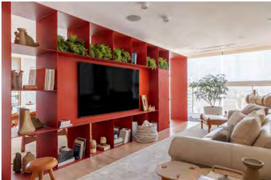
Esta estante de serralheria planejada pelo arquiteto Raphael Wittmann foi executada com chapas de 5mm soldada e pintada no próprio local. O tom bordô chama atenção e aquece o espaço.
