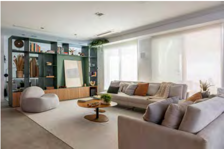
Neste projeto assinado pelo arquiteto Raphael Wittmann, a estante de metálica na área social foi entregue em módulos já compatibilizados com o tamanho do elevador e com acabamento em pintura eletrostática. Soldada no local, recebeu mais uma pintura que ampliou sua resistência
